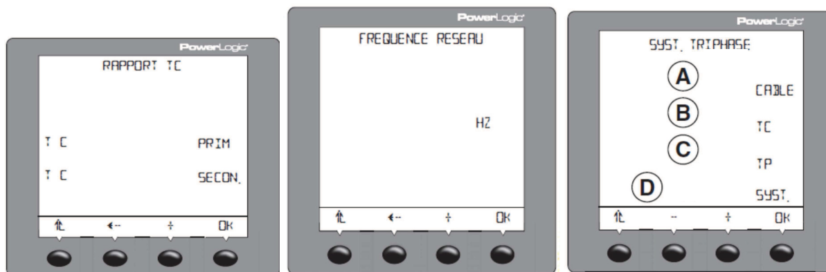
Figure 4 ( DRE2 ) Configuration de la centrale de mesure
