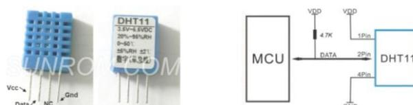
Figure 3 : Photographie et branchement d'un DHT11
